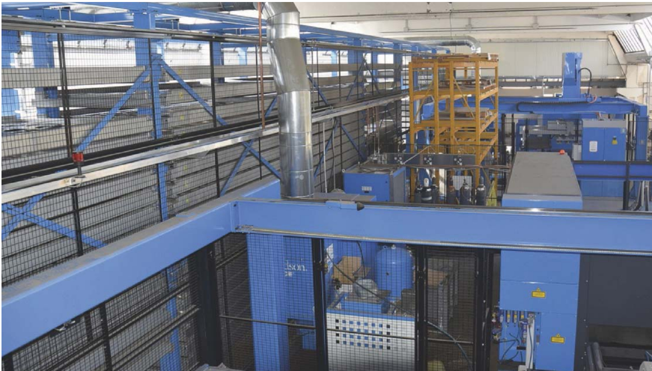
Vista dall'alto del magazzino di stoccaggio Night Train (da 104 cassetti totali, per 312 tonnellate di grezzo e/o semilavorato potenzialmente stoccabile).
