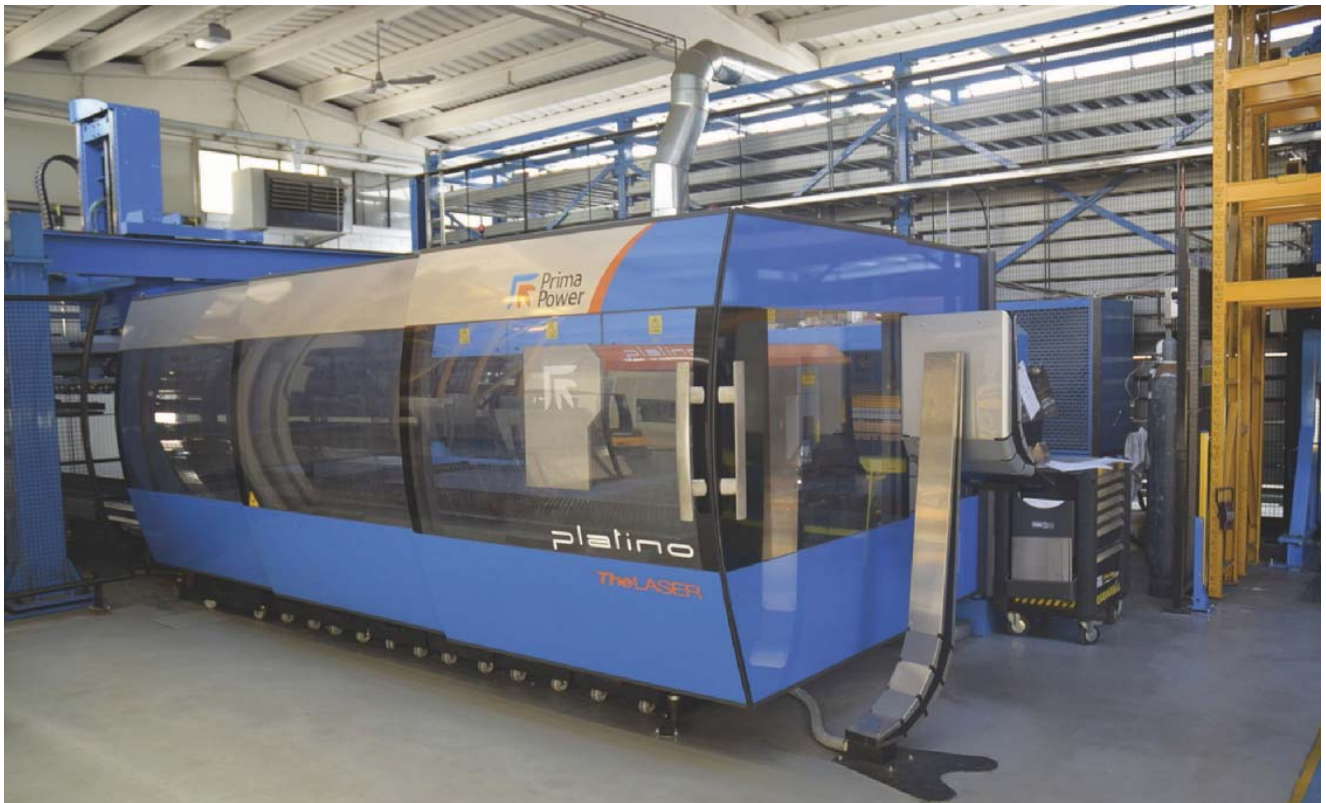
Il magazzino automatico Night Train direttamente collegato all'impianto di taglio laser con tecnologia a CO 2 serie Platino entrambi di Prima Power.
