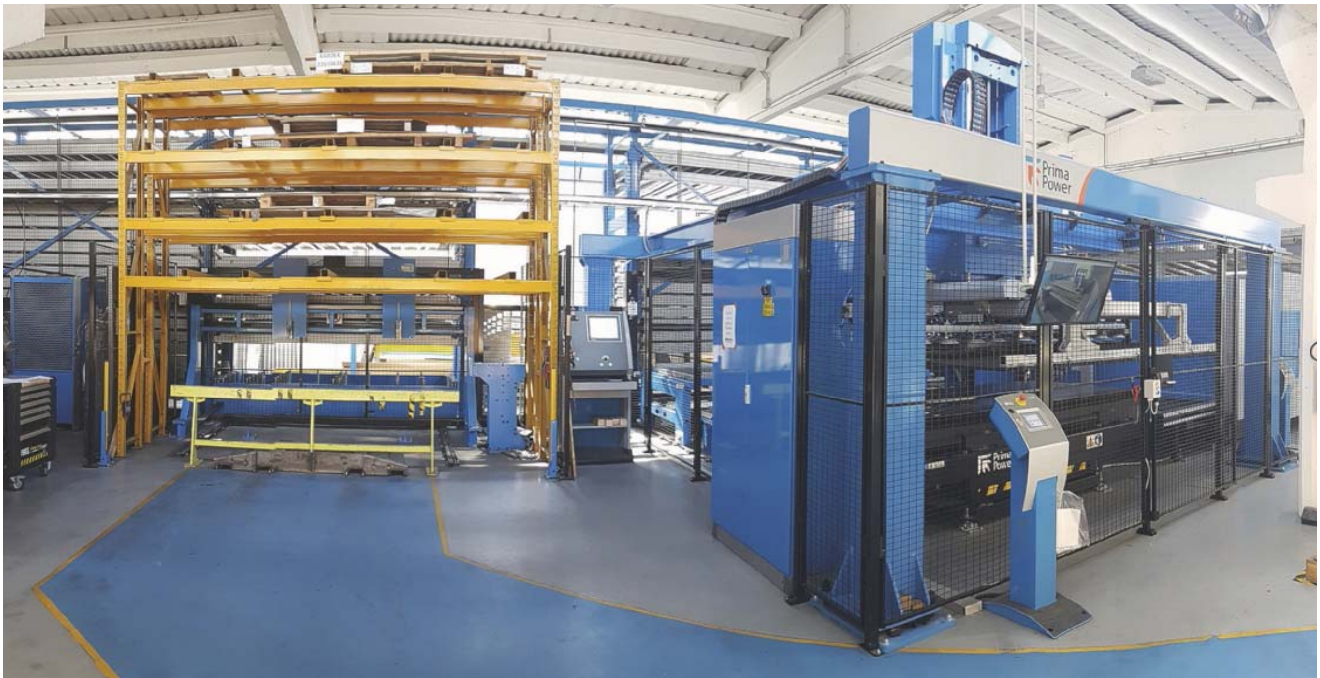
Vista del nuovo impianto per il taglio 2D con tecnologia a fibra Platino Fiber Evo Prima Power, corredato di robot di carico/scarico LU6.
